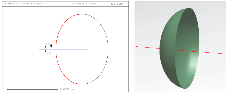
図 8.5: 短軸まわりに回転することで生成される楕円面。コーニック係数 K が K > 0 の場合に相当。 左図：楕円断面，右図：生成された回転楕円面
